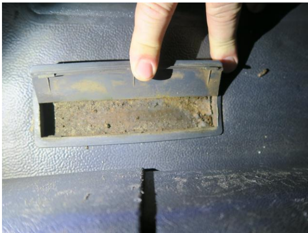
Oznaczenie identyfikacyjne skorodowane
